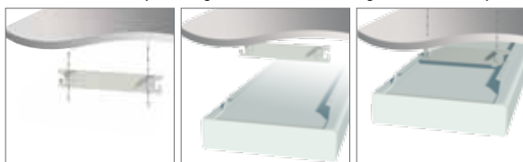
Fixation de l'étrier au plafond.
